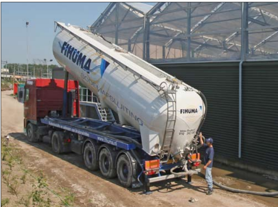
Met het oog op de aslasten overgeschakeld op trekker-oplegger combinaties.
